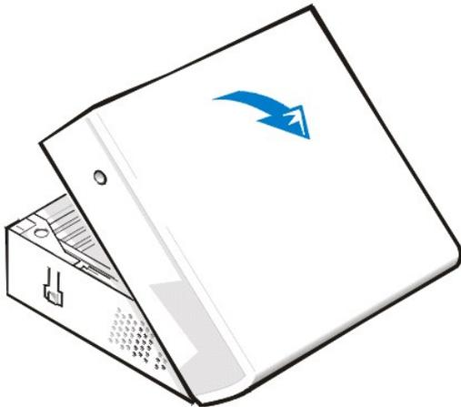
4. 如果您的计算机使用小型塔式机箱，请按以下步骤卸下主机盖：
